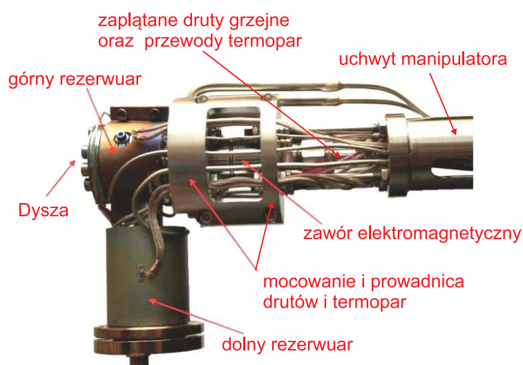
Rysunek 4.6: Fotografia modułu źródła, wraz z elementami mocującymi go do manipulatora. Na skutek niefortunnej konstrukcji prowadnicy drutów grzejnych demontaż zaworu elektromagnetycznego był praktycznie niemożliwy.
